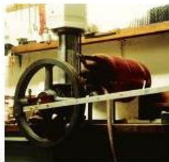
Stirling mit Pronyschem Zaum (zur Erweiterung des geschlossenen Kurbelraumes wurde als Notlösung bei diesem Stirlingmotor eine ausgeleichte Propangasflasche angeflanscht)
